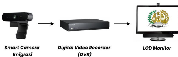
Gambar 5. Skema instalasi MARS di UPT Imigrasi
